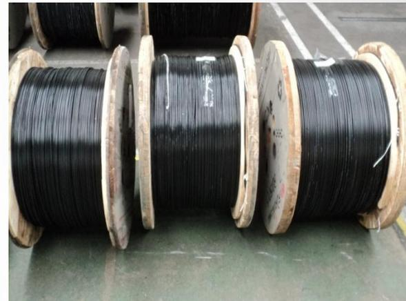
As bobinas devem ser armazenadas e transportadas apoiadas em suas flanges.
